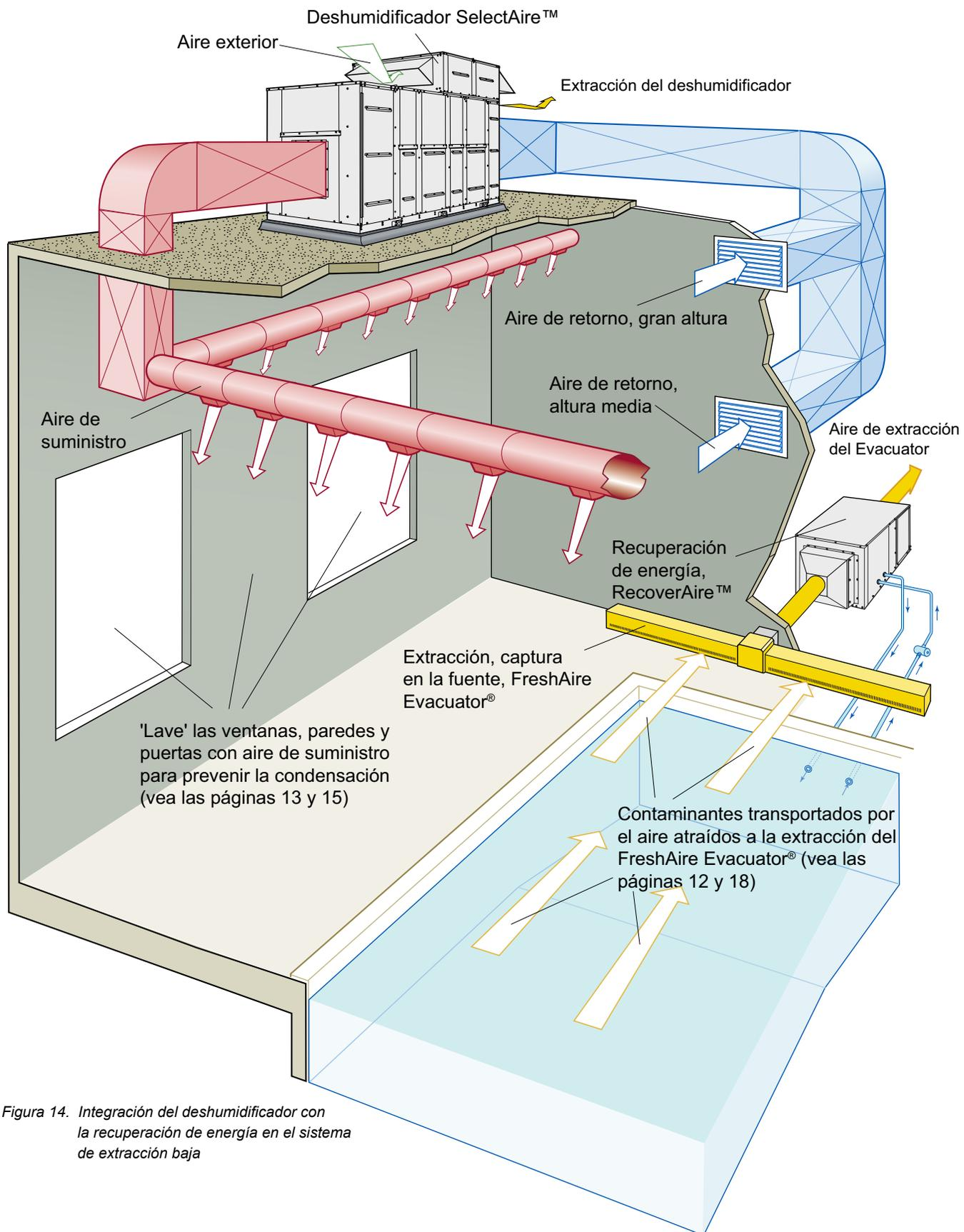
Figura 14. Integración del deshumidificador con la recuperación de energía en el sistema de extracción baja
