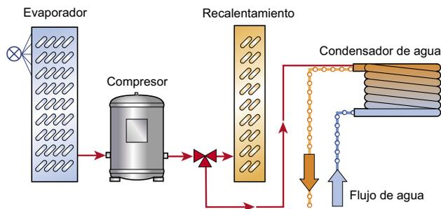
Figura 12. Esquema de refrigeración con recuperación de la piscina
