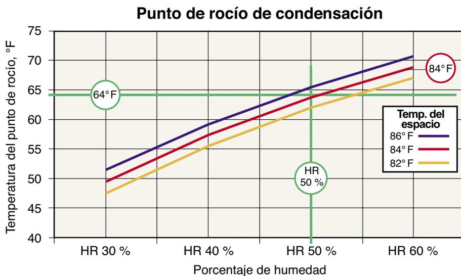
Figura 2. Punto de rocío de condensación de un natatorio
