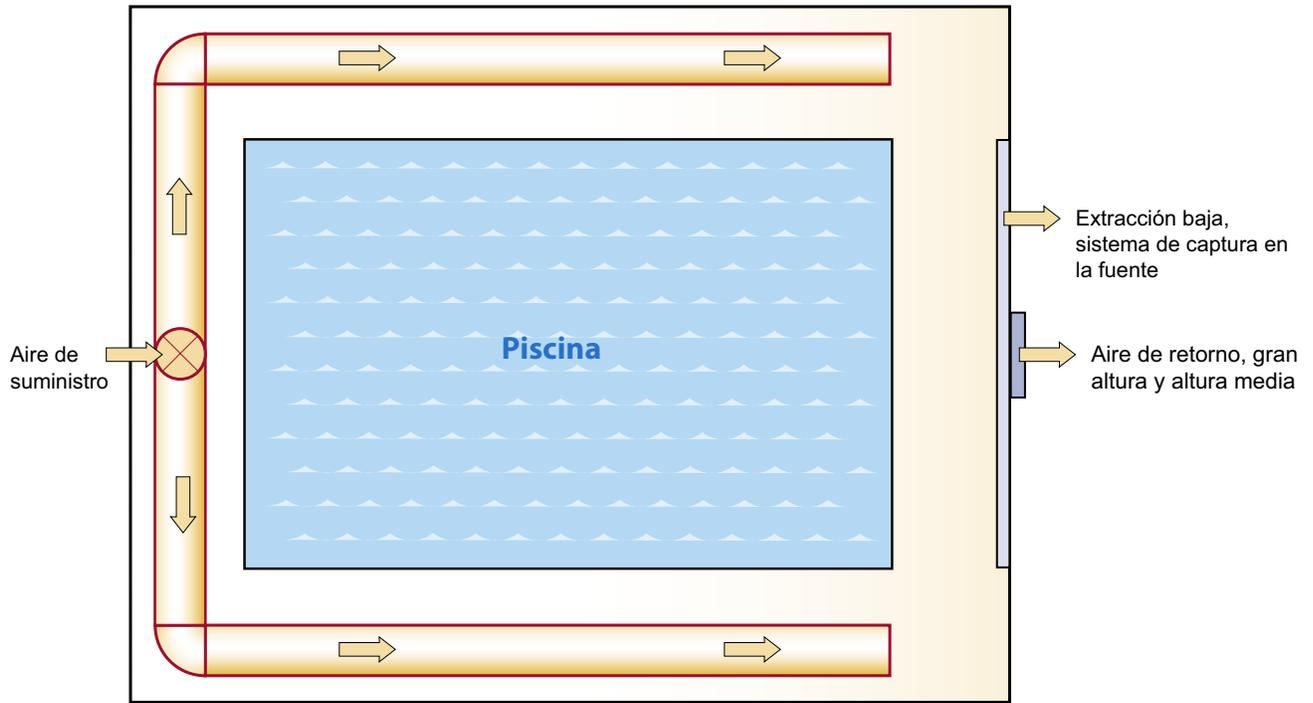
Figura 8. Vista superior del diseño del conducto
