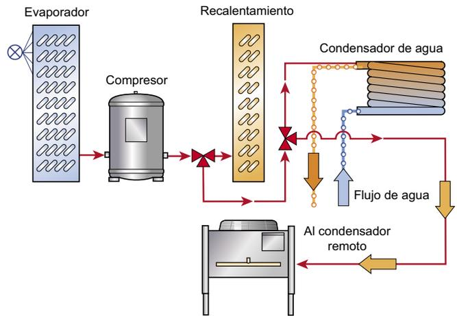
Figura 13. Esquema de refrigeración con todos los modos
