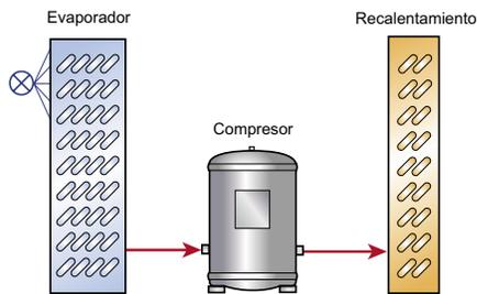
Figura 11. Esquema de refrigeración sin recuperación de la piscina
